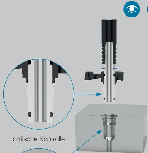
**2.** Stecker bis zum Anschlag in die Muffenkontur einstecken. Der Stecker ist tief genug gesteckt, wenn die Kunststoffverriegelung danach nur noch einen kleinen Spalt ( $< 1 \text{ mm}$ ) zum Einschraubstutzen bzw. zur Hydraulikkomponente aufweist.
