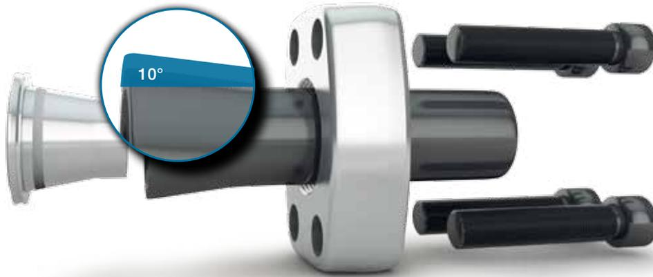
Im Vergleich zum herkömmlichen Bördelwinkel von 37° verwenden ZAKO-Flanschsysteme einen Winkel von 10° mit kleinen Sägezähnen in der Bördelzone. Unsere jahrelange Erfahrung mit diesem System sowie umfangreiche Kräftermessungen zeigen erhebliche Vorteile in Bezug auf Stabilität und Sicherheit der Verbindung. Durch die Aufweitung des Rohres um lediglich 10° wird das Material zudem nicht überdehnt und bleibt somit elastisch genug, um auch höchste Biegewechselbeanspruchungen zu kompensieren.
