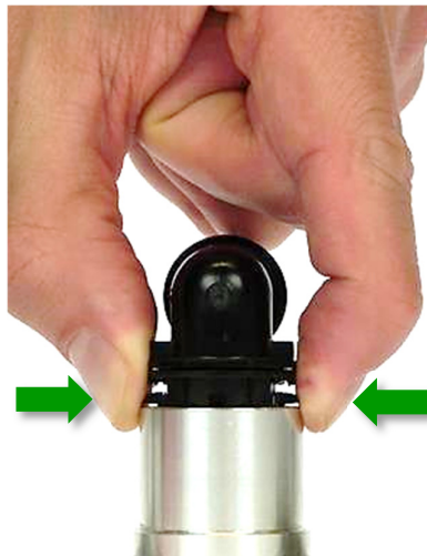
Abb. 28: Zusammendrücken des Halteelements von Stecker 271
