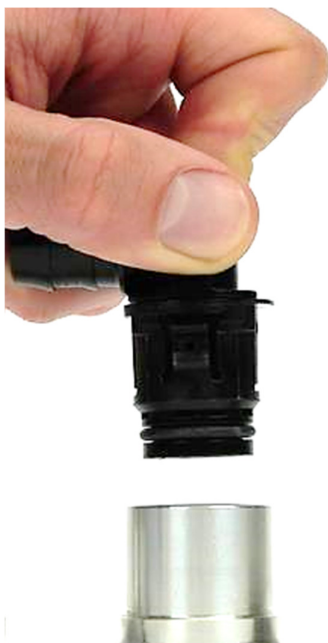
Abb. 9: Mittige Platzierung des Steckers 271 über Anschlussbohrung
