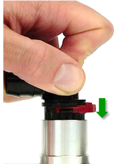
Abb. 12: Stecken des Steckers 271 DL in Anschlussbohrung
