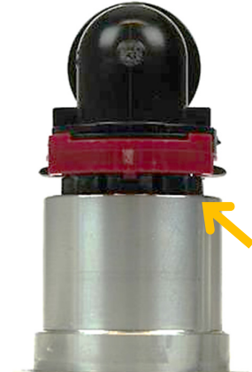
Abb. 14: Unvollständige Montage Stecker 271 DL : Blockierter Double Lock Montageanleitung VOSS Stecksysteem 271, Seite 7 von 14
