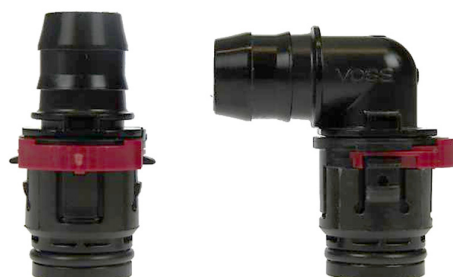
Abb. 4: Gerader und Winkelstecker 271 DL , Halteelement & Double Lock können um 90° gedreht sein
