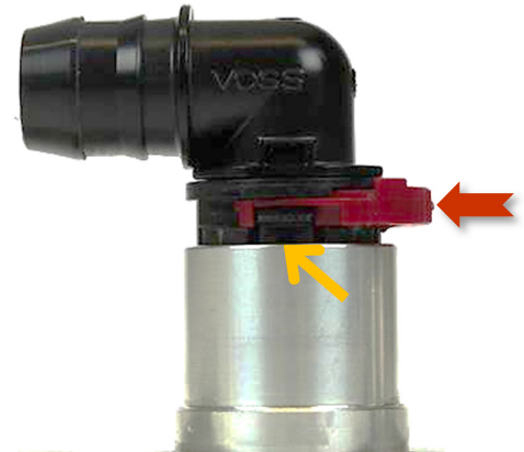
Abb. 12: Stecken des Steckers 271 DL in Anschlussbohrung
