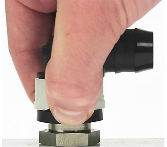
Abb. 38: Fassen des Haltelements bei Kupplung 270
