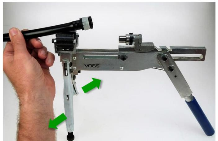
Abb. 18: Lösen der Gripzange
