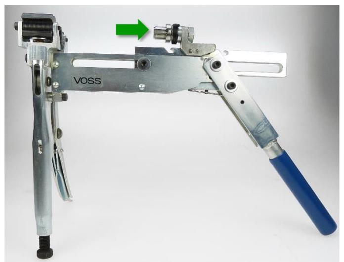
Abb. 9: Einsetzen des Werkzeugeinsatzes
