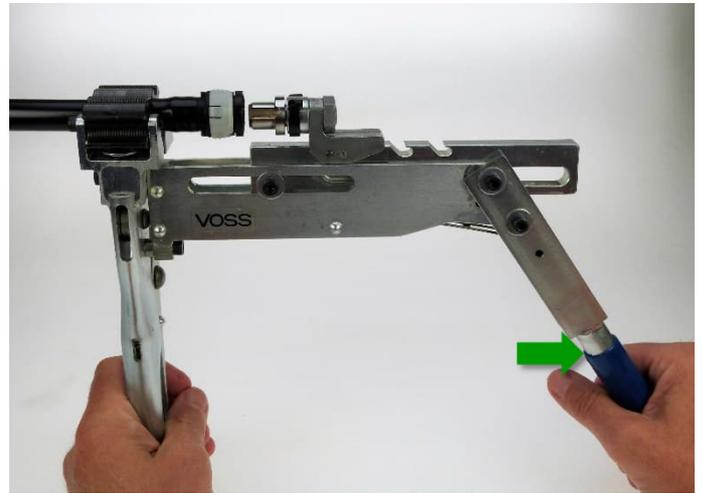
Abb. 16: Zurückziehen des Einpresshebels
