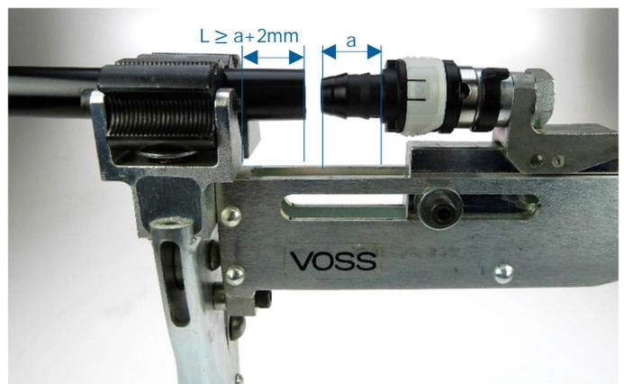
Abb. 12: Einlegen des Kunststoffrohres
