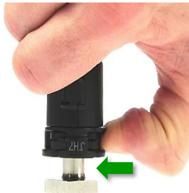
Abb. 23: Drücken der Halteklammer Kupplung 241 N
