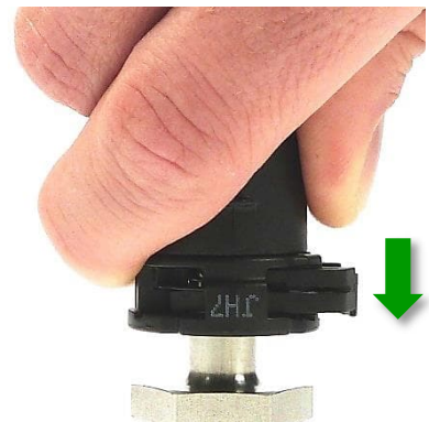
Abb. 35: Bis zum Anschlag gesteckte Kupplung 241 N-SL (Wiederholmontage)
