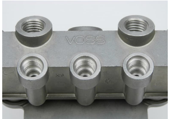
Abb. 11: Saubere und korrekte Anschlussbohrungen
