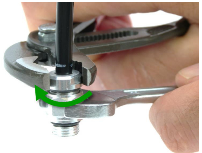
Abb. 17: Ausschrauben des Dichtpakets aus der Überwurfschraube
