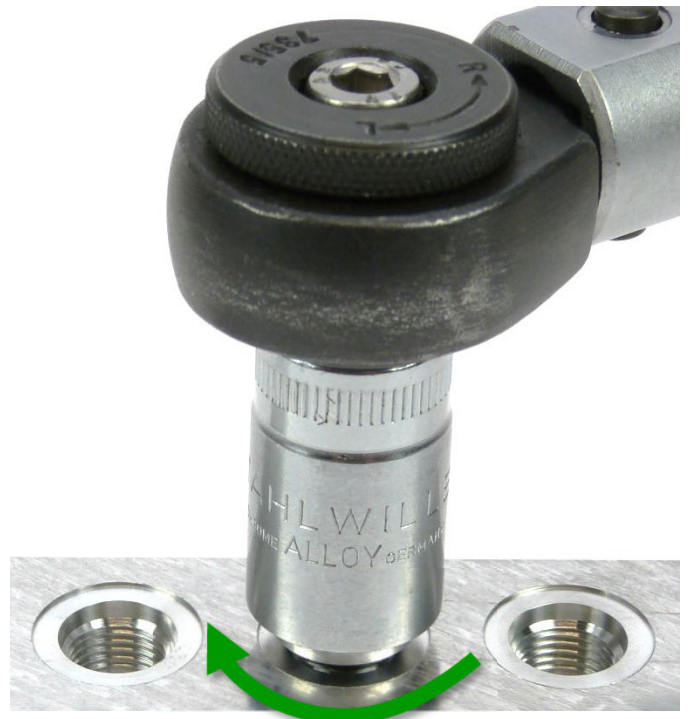
Abb. 11: Anziehen mittels Drehmomentschlüssel
