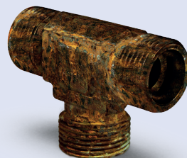
Zink + Passivierung + Versiegelung
