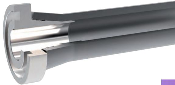
**3.3** Konischen und zylindrischen Bereich des Kragenringes zur Verminderung der Montagekräfte gut mit Schmiermittel (z. B. mineralölbasiertes Hydrauliköl HLP32) versehen!
