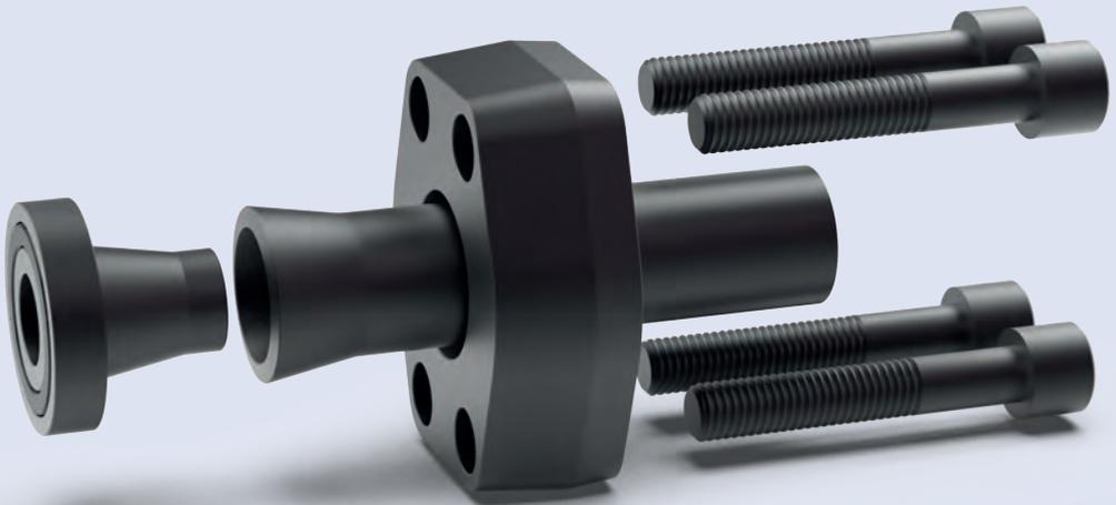
Im Vergleich zum herkömmlichen Bördelwinkel von 37° verwenden ZAKO-Flanschsysteme einen Winkel von 10° mit kleinen Sägezähnen in der Bördelzone. Unsere jahrelange Erfahrung mit diesem System sowie umfangreiche Kräftemessungen zeigen erhebliche Vorteile in Bezug auf Stabilität und
