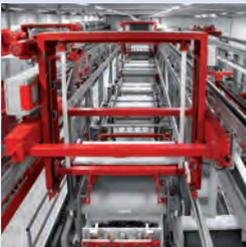
Durch Prozessoptimierungen ist die Zeit, in der sich die Produkte in der Trommel befinden, wesentlich kürzer als bei anderen Galvanisierungsbetrieben. Dies schont das Material zusätzlich.
