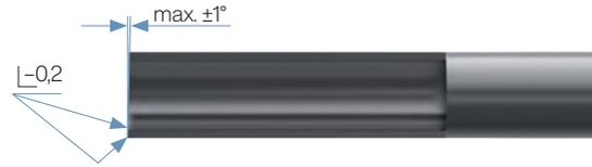
**3.3** Rohrenden innen und außen leicht entgraten, Rohrleitung reinigen.
