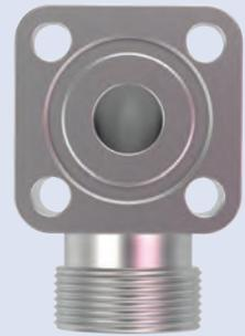
Die Flanschverschraubungen mit quadratischem Flanschanschluss zeichnen sich durch besonders geringe Außenabmessungen aus. Sie werden in gerader und winkelliger Ausführung geliefert. Das Programm umfasst die Rohraußendurchmesser von 10 mm bis zu 42 mm. Die Flanschabdichtung erfolgt durch einen elastischen Runddichtring (O-Ring), der Montageanschluss durch Zylinderschrauben. Die Flanschanschlüsse sind auf die Anschlusslochbilder führender Pumpenhersteller ausgerichtet.
